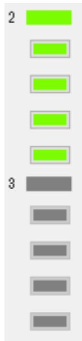
▲図 3.2 拡張ボード情報：拡張ボード 2 は接続され、3 は接続されていない状態
